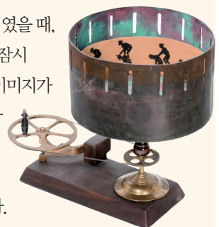
조트로프(1834년경)-연속적인 동적이 그려진 종이띠를 회전시키고 바깥쪽에 세로로 된 구멍으로 보면 눈의 잔상과 착시에 의해 움직이는 것처럼 보인다.
