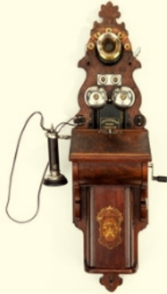
L사(스웨덴) 자석식 벽걸이 전화기 (model 301/1891년 작) 우리나라에서 사용한 초기 전화기의 모습
